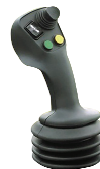
Joystick ergonomicamente projetado para controlar todas as funções da empilhadeira
